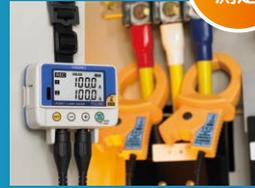
クランプロガーで電力測定
