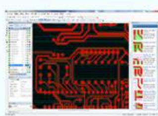
ガーバー / ドリルデータの読み込み、レイアウト作図、多面取り配置、基板加工機やレーザ加工機データ最適化生成、データ作画作成・編集・Gコード出力を備えたCAMソフトです
