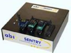
2ピンデバイスからより複雑なBGAなどパッケージまで、付属パソコンソフトによるライブラリ比較により、不足／不正確なピン配置とピンインピーダンス変化を検出し、偽造ICや偽造部品を簡単操作で素早く発見します。
