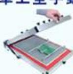
作業机上で専門知識不要の簡単操作でクリームはんだ印刷ができる、小型で分散設置可能なSMT実装用機器です。
