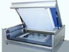
メタルマスク製造時の検査や使用前後の保守検査を、メタルマスク・スクリーン版などをスキャンし、良品データやガーバーデータと比較し、開口位置・開口形状・開口数を検査します。
