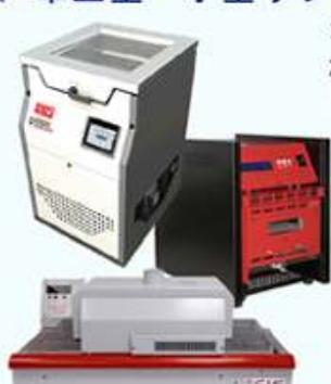
コンパクトな小型リフロー炉は自由に配置設置でき、大型リフローなみのプロファイルが可能で、SMT基板実装時のはんだ硬化や接着剤硬化ができ、鉛フリーはんだにも対応しています。
