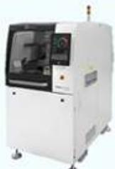
基板グリップ固定方式により切断ストレスなしで、自在な形状の厚板プリント基板も高速で切断分割します。搭載部品の高さ制約が小さい基板下面からのルーターPCB切断方式を採用、強力吸塵機構により切削粉浮遊付着が極めて少なく、分割後基板を自動でエアーブローし通い箱やトレーなどに自動整列収納します。
