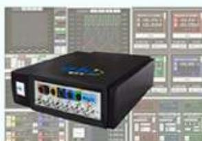
1台で、同時に使えるオシロ・発振器・ユニバーサルカウンタ・マルチメータ・定電圧定電流直流電源・プログラマブル信号入出力I/O機能を備え、信号印可、電圧電流測定、波形観測など8種の計測器機能を使えます。
