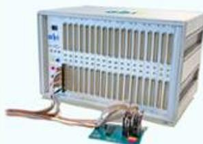
故障基板も含めた部品実装基板やベアーボードから、回路図を自動生成し、基板データを作成できます。廃番部品を現況部品に置換した回路図も、連動基板 CADにより、復元基板やリニューアル基板を作製できる、リバースエンジニアリングの回路図復元基板復元システムです。
