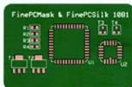
プリント基板加工機で作成した基板に、はんだレジスト・シルク印刷を施し、短時間の簡単作業で、量産基板とそん色ない絶縁性ある実装しやすい基板を、作業机上で作成できます。
