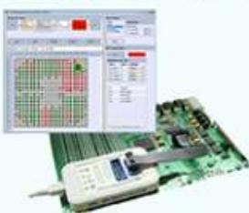
検査プローブ接続が不可能なデバイス検査も、チップ内部を数珠つなぎにし内部状態を順番に読み出すバウンダリスキャンテストと、ロジックデバイス(PLD)プログラミングの両方を行えます。
