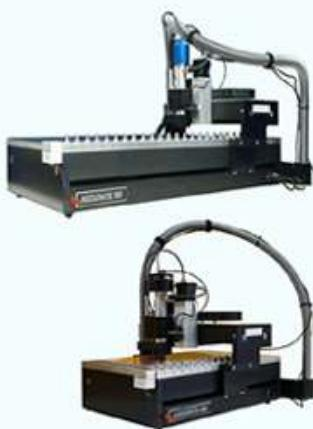
トップクラスの高精度・高速性能、簡単操作で、長期間信頼性、幅広い活用性を備え、基板材料の設置操作以外ほぼ完全自動。XYZ三軸サーボ制御による高精度繰返し位置精度で、配線パターン加工・穴あけ・外形切断を行い、ガラエボ基板・フェノール基板・高周波材基板・フィルム配線板・薄板基板・厚銅基板など多彩な基板を、高速性能で短時間に作製する、堅牢な高性能プリント基板加工機です。
