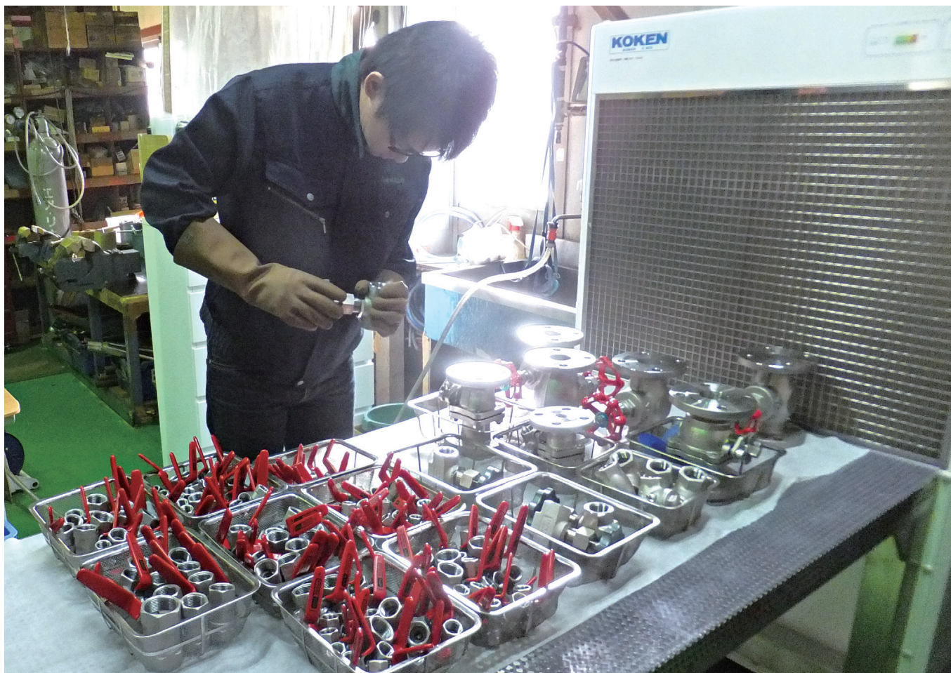
KOACHのクリーン空間で洗浄後の製品の乾燥・梱包を行うことが、他社ではできない品質へのこだわりとなり差別化を実現している
