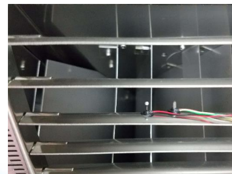
恒温槽内吹き出し部の風速・風温評価
