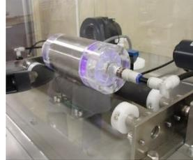
九州産業大学、福岡県工業技術センター化学繊維研究所の知見をもとに開発。大気圧で発生するプラズマ(グロー放電)によりポリマー表面の親水化や官能基の付加を行える。ローラー式放電セルの工夫により、均一で効率的な試料の処理が可能です。
